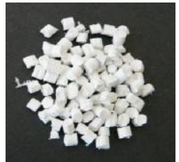
CBT als Träger in Masterbatch: 80 Gew% TiO 2
