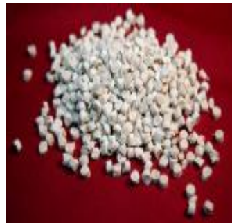
CBT als Träger in Masterbatch: 50 Gew% Nanomer® Konzentrat
