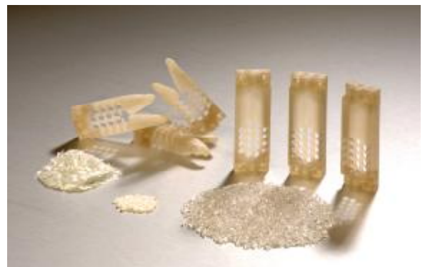
Teijin Panlite L1225 Z: PC mit 40% GF Teilen, rechts mit CBT hergestellt.
